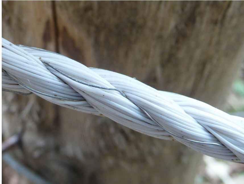
Cordino sintetico da 7 mm 6 con conduttori in acciaio (TLD 7) con caratteristiche antistrappo (resistenza allo strappo 700kg).
